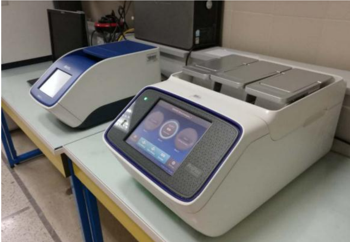
Figure 30 : Thermocycleurs de l'unité de génétique médicale et d'oncogénétique du CHU HASSAN II de Fès.
