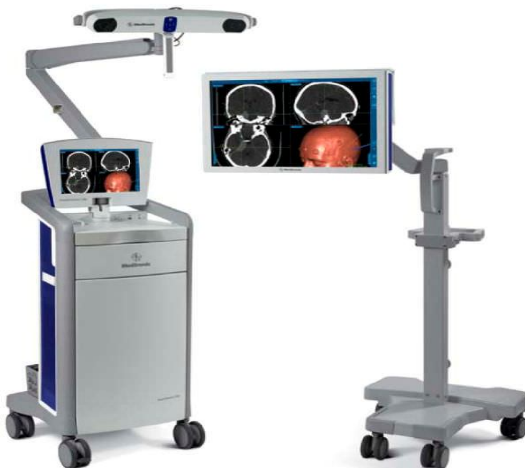
Figure 80 : Station de NAO équipée d'un système optique : le référentiel spatial résulte d'une batterie de trois caméras infrarouges qui déterminent la position d'un instrument muni d'émetteurs infrarouges ou de capteurs réfléchissant les infrarouges.
