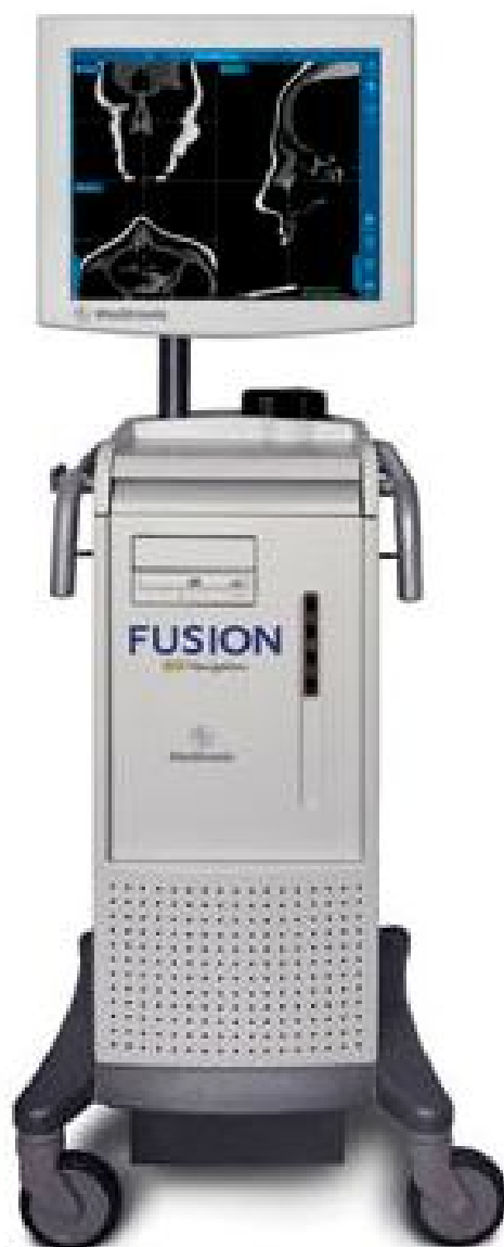
Figure 81: Station de NAO équipée d'un système électromagnétique : le référentiel spatial résulte de la création d'un champ électromagnétique englobant la zone opératoire, dans lequel la position d'un instrument couplé à un support électromagnétique va pouvoir être déterminée.
