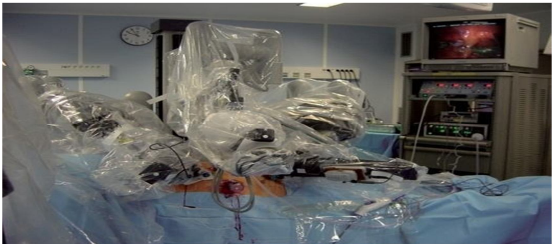
Figure 48: Disposition des bras du robot au-dessus du patient et positionnement des trocars [107]
