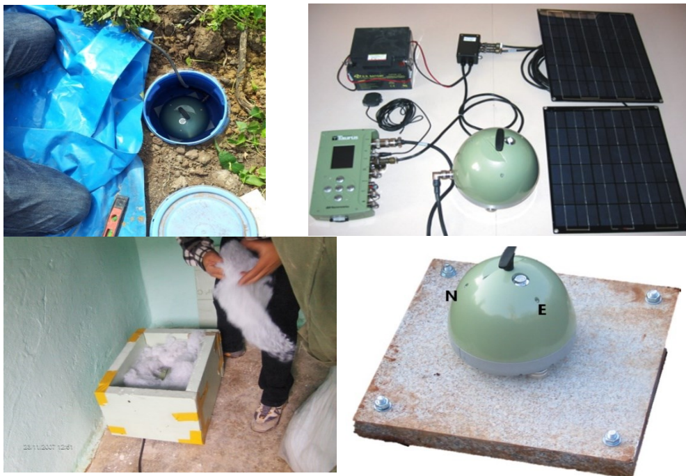
Figure 1. 13 : L'installation typique proposer pour l'installation d'une station Broadband de type Nanometrics Trillium 120PA
