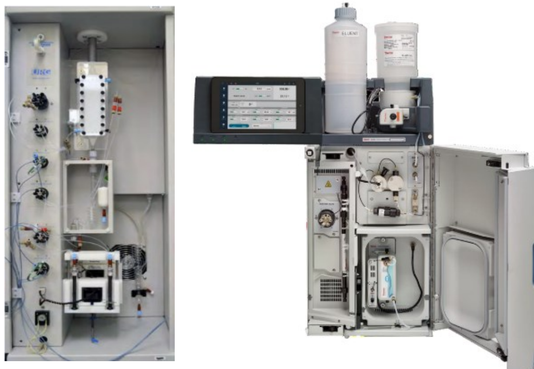
Figure 2. 9 : AIM (droite) et le chromatographe des ions (gauche), photo de l'intérieur des systèmes
