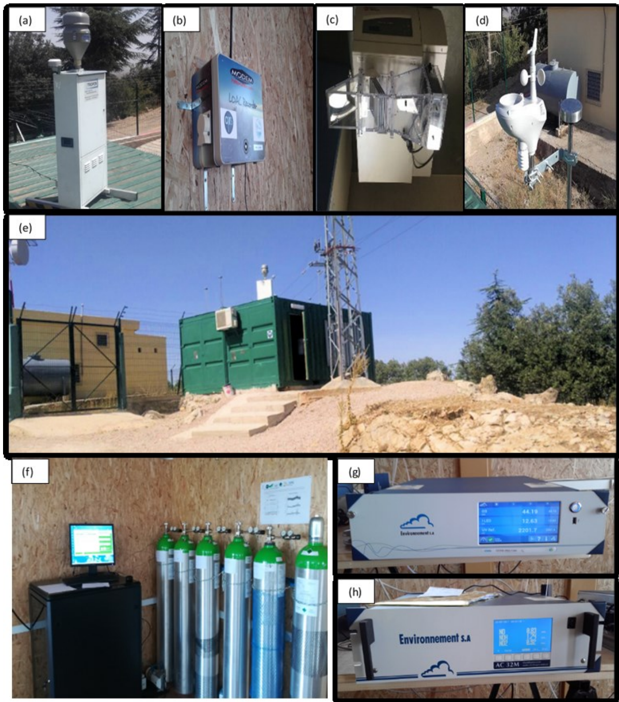
Figure 2. 21 : parc instrumental de la station Atlas UM5, (a) c'est le Digital PM10, (b) LOAC pour le calcul de la distribution de particule par taille, (c) capteur de brouillard, (d) station météo, (f) Picarro Analyseur des gaz à effet de serre, et (g) (h) les deux moniteurs O 3 , NO x
