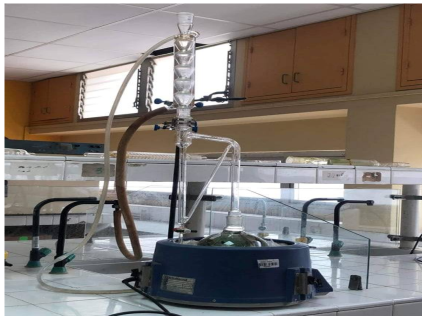
Figure 33: montage de l'hydro distillation : chauffe ballon, ballon , Clevenger, réfrigérateur (photo prise au laboratoire de chimie analytique)
