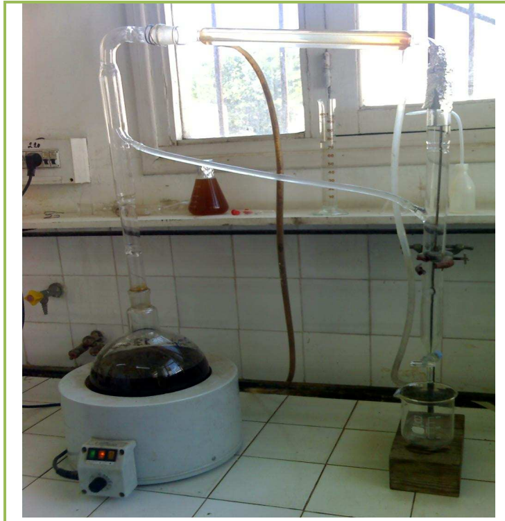
Figure 8 : Appareillage de l'hydrodistillation
