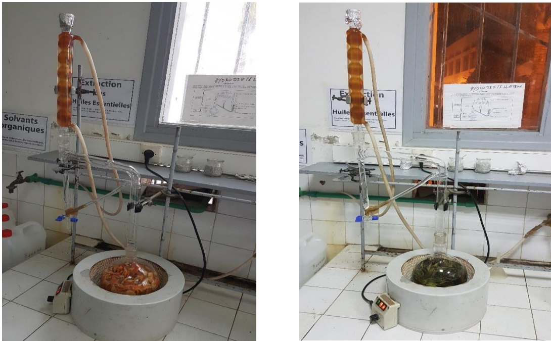
Figure II- 5: Dispositif d'hydrodistillation (extraction des HES des écorces et des feuilles de citrus)
