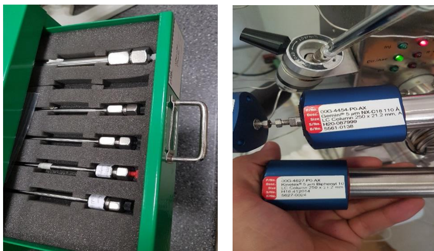
Figure III- 13: Différence entre colonne préparative et colonne semi-préparative
