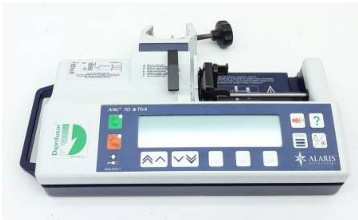
Figure 7: Seringue auto pousseuse (diprifusor)
