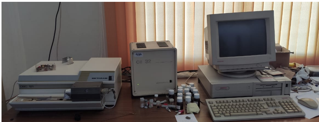
Figure 7. Dispositif de mesure par la DSC (SETARAM 121 apparatus).
