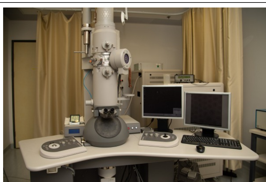
Figure 3. Constitution d'un MET (figure reproduite à partir de la référence [5]).
