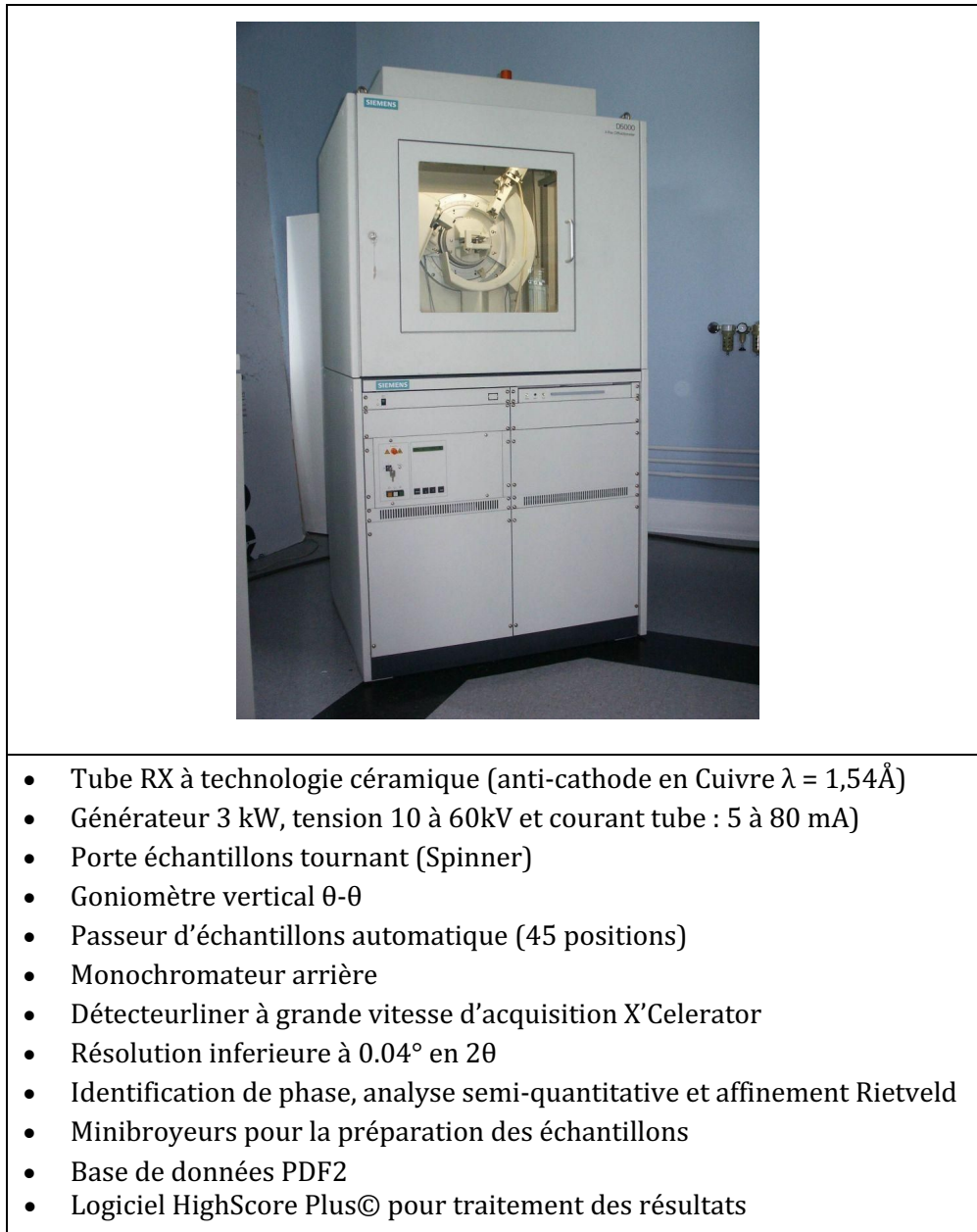
Figure 2. Caractéristiques techniques de la DRX (Siemens D5000) [4].
