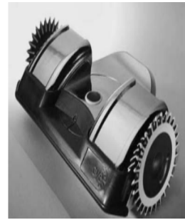
(b) La configuration à deux roues motrices
