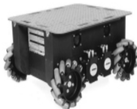
(k) La configuration omnidirectionnelle à quatre roues sphériques
