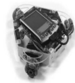
(j) La configuration omnidirectionnelle à trois roues sphériques
