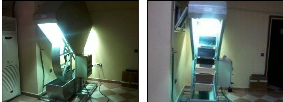
Figure IV.14. Equipement pour l'essai de vieillissement à la roue de dégradation GARDNER
