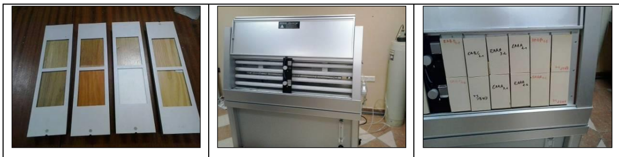
Figure IV.12. Photos de l'équipement de l'essai de vieillissement artificiel au QUV
