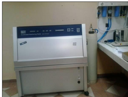
Figure IV.12. Photos de l'équipement de l'essai de vieillissement artificiel au QUV
