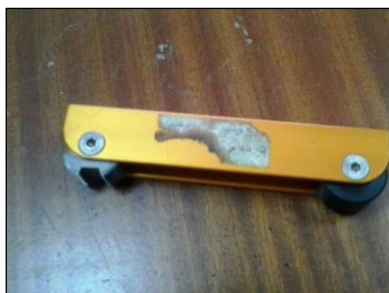
Figure IV.9. Photo de l'outil utilisé pour l'essai d'adhérence par quadrillage
