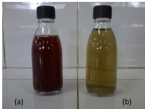
FIGURE 7.35: Solution des margines avant la réaction de lixiviation - agent lixiviant (a) ; Solution de lixiviation après la réaction de lixiviation - lixiviat (b)
