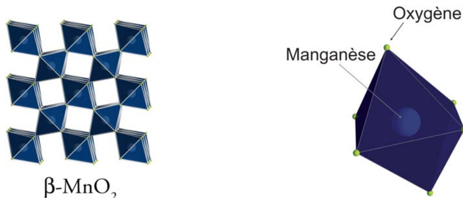
FIGURE 1.3: Représentation d'un octaèdre de coordination du manganèse. L'atome de manganèse est au centre, et coordonné à six atomes d'oxygène qui forment les sommets d'un octaèdre
