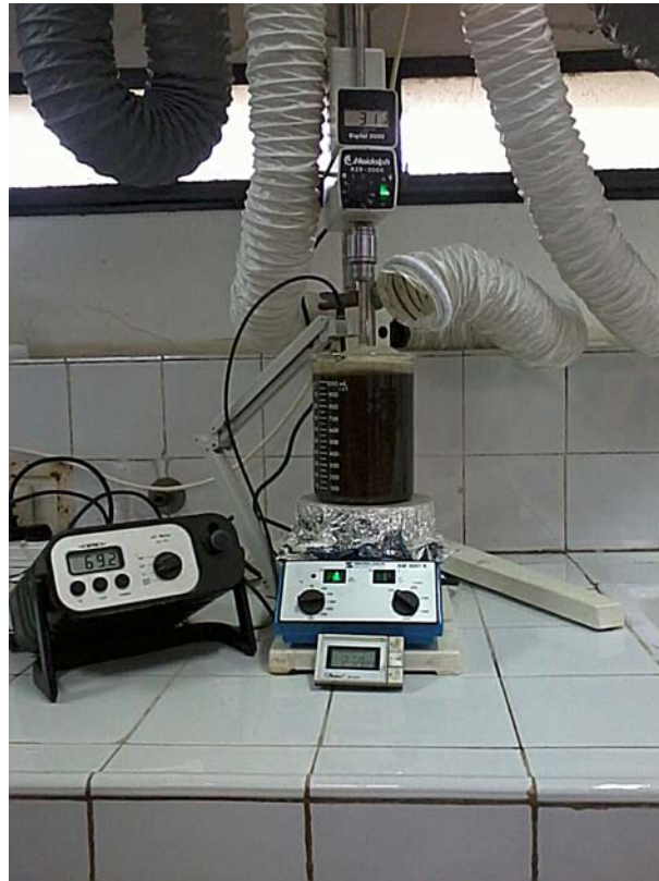
FIGURE 7.34: Montage de préparation du lixiviat en grande quantité sous les conditions de marche optimales
