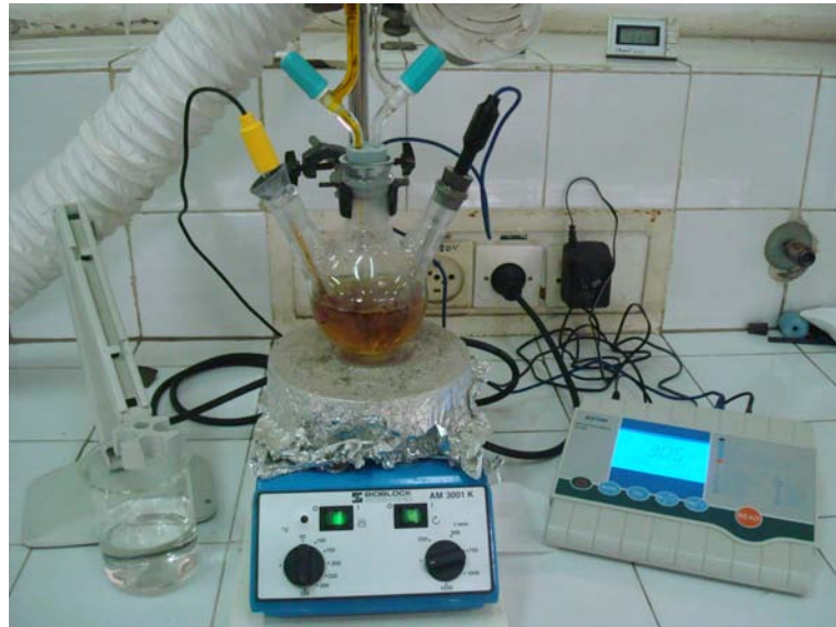
FIGURE 7.43: Montage expérimental pour les essais de précipitation de MnS par HS^-
