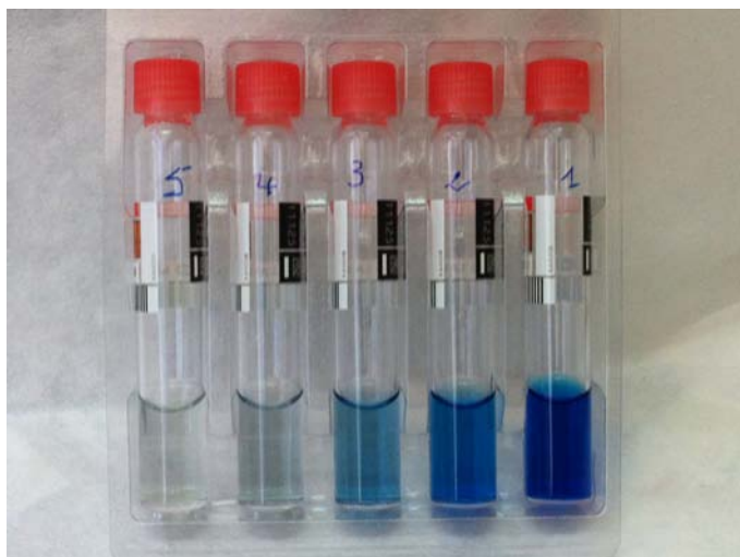
FIGURE 8.19: Photo des échantillons pris lors de la dégradation oxydative du BM
