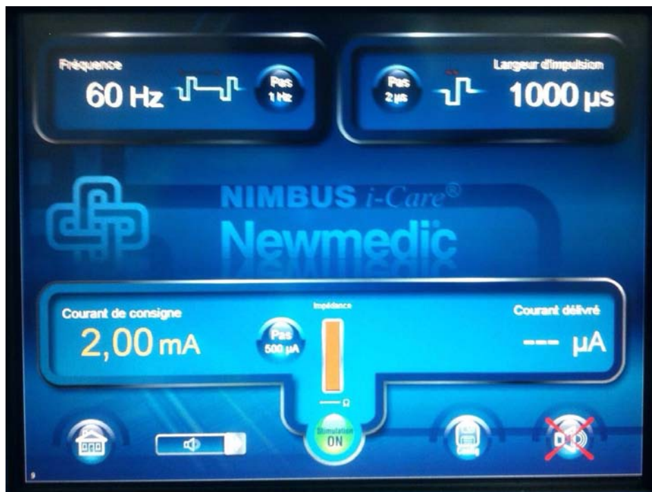
Figure 10 : Ecran affichant les différents paramètres de stimulation électrique directe.
