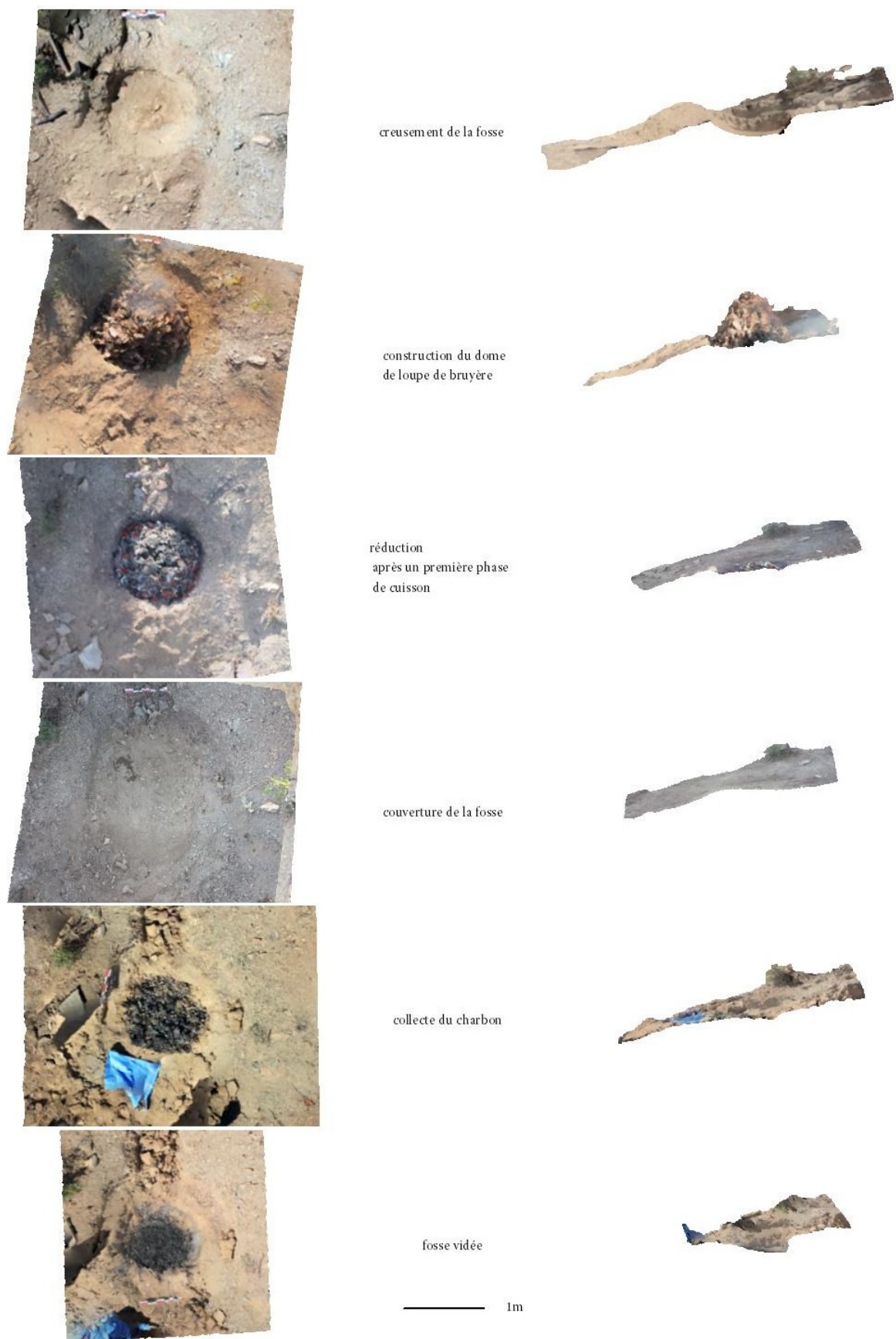
Fig 4. Les différentes phases de la fabrication de charbon de bois en fosse de la cuisson réalisée les 26 et 27 septembre 2018 par A. Dahmani dans le bois domanial de Timdiwane (Jbel Oudka). Relevé photogrammétrique et traitement V. Bernollin.
