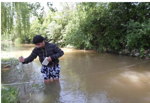
Photo 44: Exploration du champ des vitesses, Source Ribaa. (12 avril 2015)
