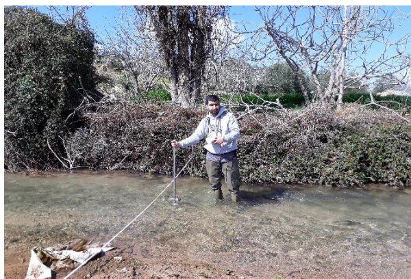
Photo 43: Exploration du champ des vitesses, source Ghara. (25 fév. 2018)
