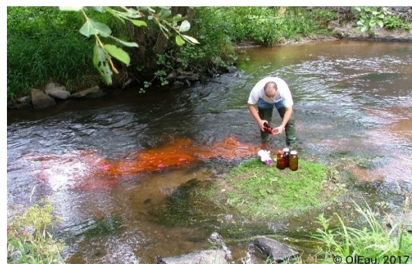
Photo 37: Jaugeage par dilution. (Https://www.iowater.org/)
