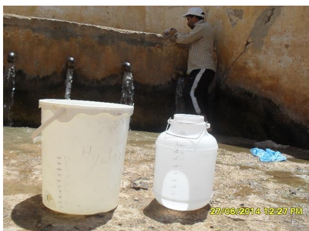
Photo 34: Jaugeage capacitif dans la source d'Aïn Smen. (27 Juin 2014)
