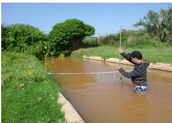
Photo 42: Exploration du champ des vitesses dans une section canalisée, source de Bittit. (12 avril. 2015)
