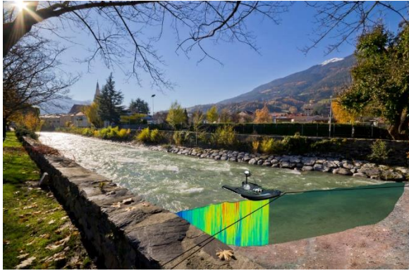
Photo 39: Mesure de débit par l'ADCP. ( https://www.adcpro.fr/ )
