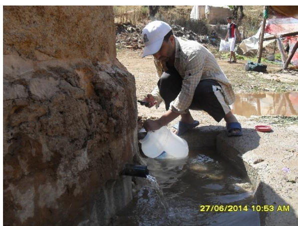
Photo 33: jaugeage capacitif aux sources Aïn Chkef. (27 Juin 2014)
