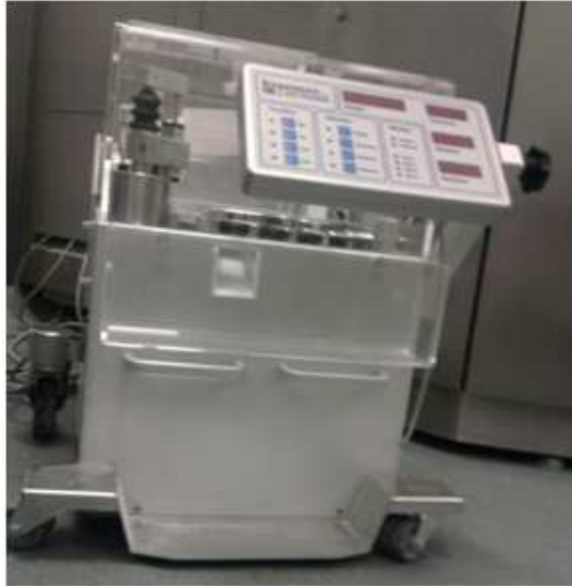
Annexe 3 : photos montrent la presse à comprimer courtoy ainsi que son système de contrôle
