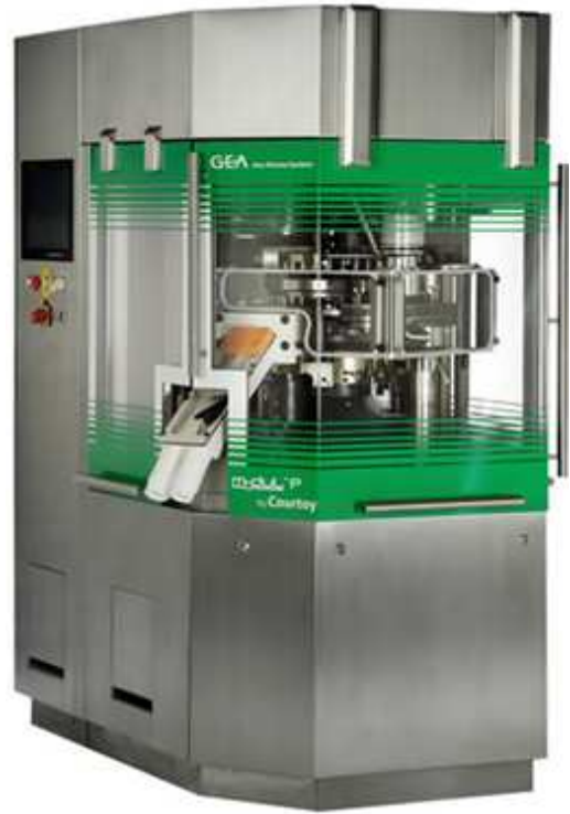
Annexe 3 : photos montrent la presse à comprimer courtoy ainsi que son système de contrôle
