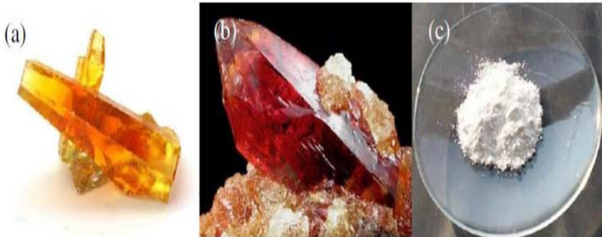
Figure 9 : Oxyde de zinc : (a, b) cristaux naturels et (c) poudre artificiellement par synthèse sol-gel.
