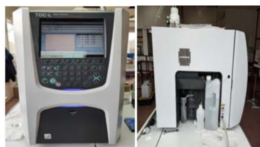
Figure B-6 : Analyseur de Carbone Organique Total (COT)
