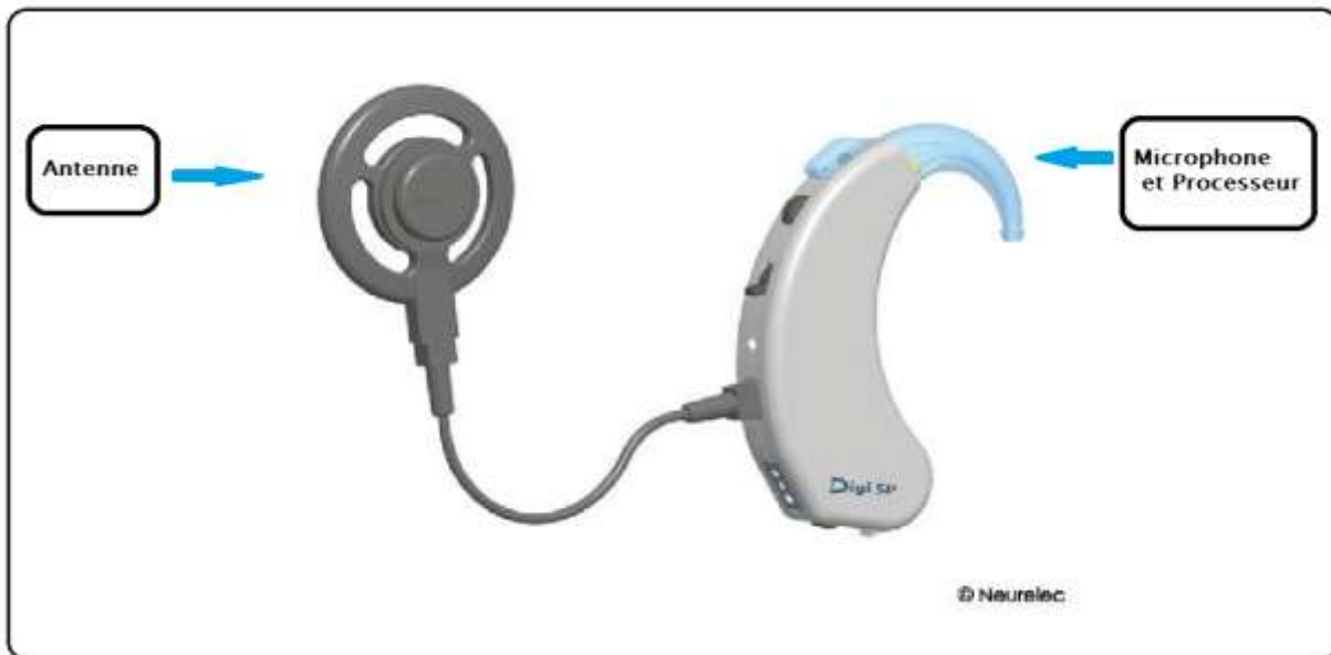
Figure13 : Partie externe d'un implant cochléaire : Marque Neurelec® [48].
