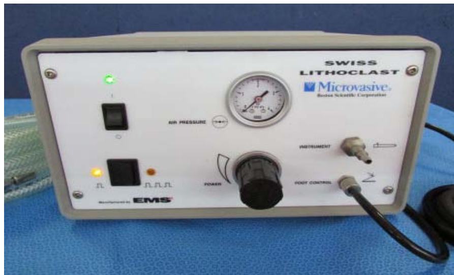
Figure 96: Swiss lithoclast destiné à la fragmentation pneumatique balistique des calculs [96].
