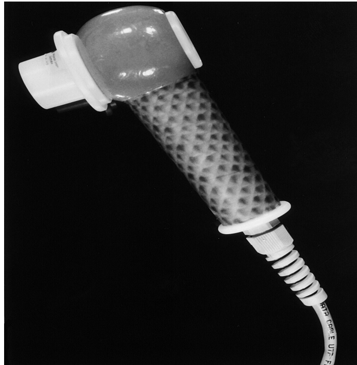
Figure 14 : Illustration de l'appareil respiratoire SpiroGame, conçu comme un cornet de glace.
