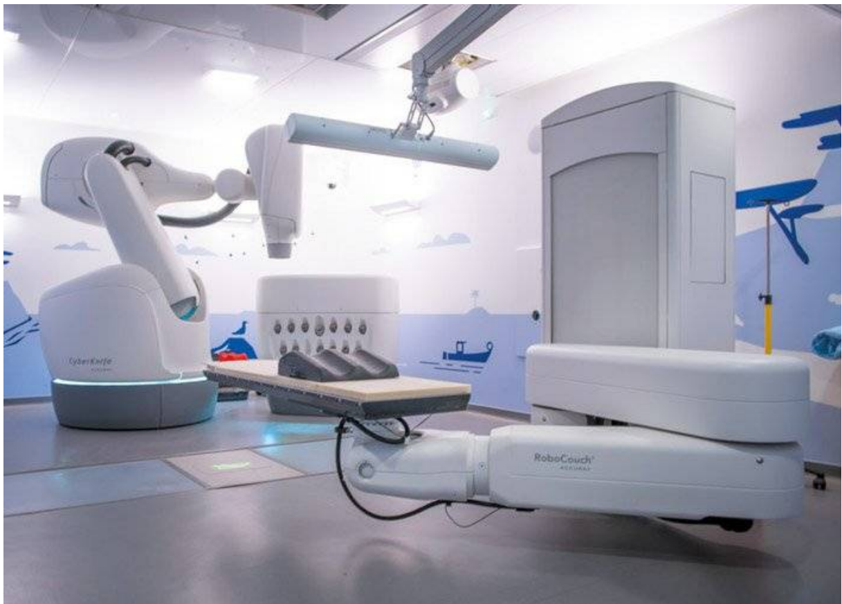
Figure 18: le robot autonome cyberknife pour la radiothérapie
