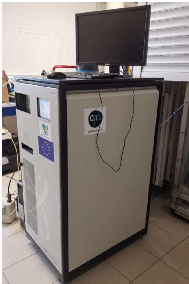
Figure II.7: Spectromètre de masse à temps de vol et à transfert de protons(IONICON) utilisé dans ce travail.
