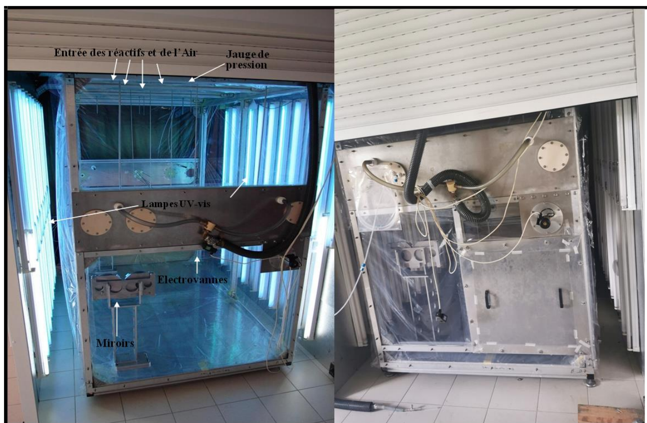
Figure II.6 : Photos de l'extérieur de la chambre de simulation atmosphérique de 7300 L
