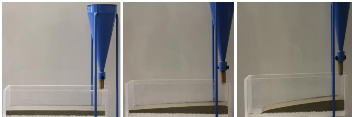
Fig. 62. Profil d'écoulement dans le canal horizontal selon la viscosité de liant
