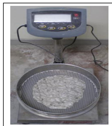
Fig. 33. Procédure d'essai de la stabilité au tamis
