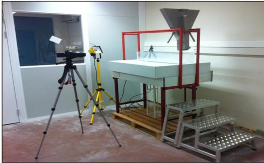
Fig.1. étude expérimentale de l'écoulement des bétons
