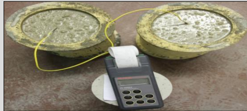
Fig. 56. Mesure de l'évolution de la température au cœur de béton à l'aide des sondes
