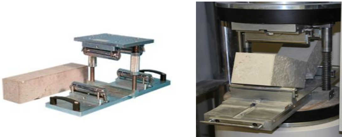
Fig. 50. Conduite de l'essai de rupture en traction par flexion
