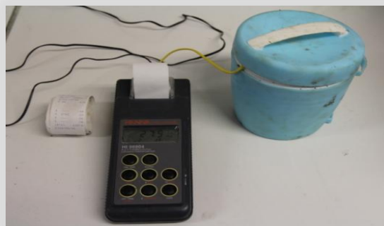
Fig. 128 : Dispositif de mesure de température au cours de la prise
