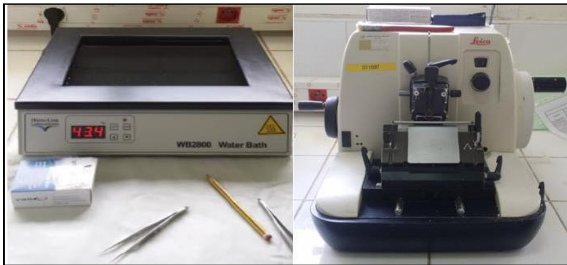
Figure 19. Bain marie (WB2800) et Microtome (LEICA RM 2135)
