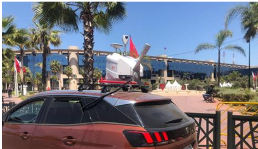
Figure 59. Unité de Scanner Laser embarqué sur véhicule Leica Pegasus à Rabat
