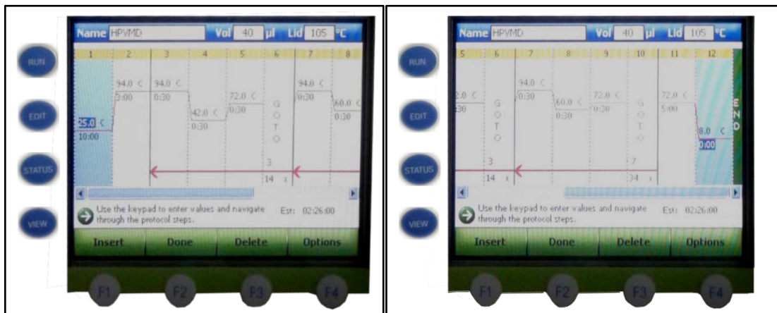
Figure 8 :Placement des tubes de PCR préparés dans le thermocycleur pour amplification del'ADN et profil thermique de la PCR
