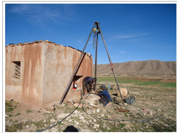
Photo 1.2. Récupération d'une sonde piézométrique
