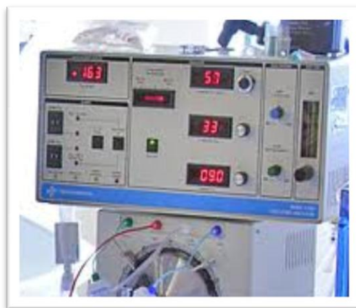
Fig.52: Appareil de jet-ventilation
