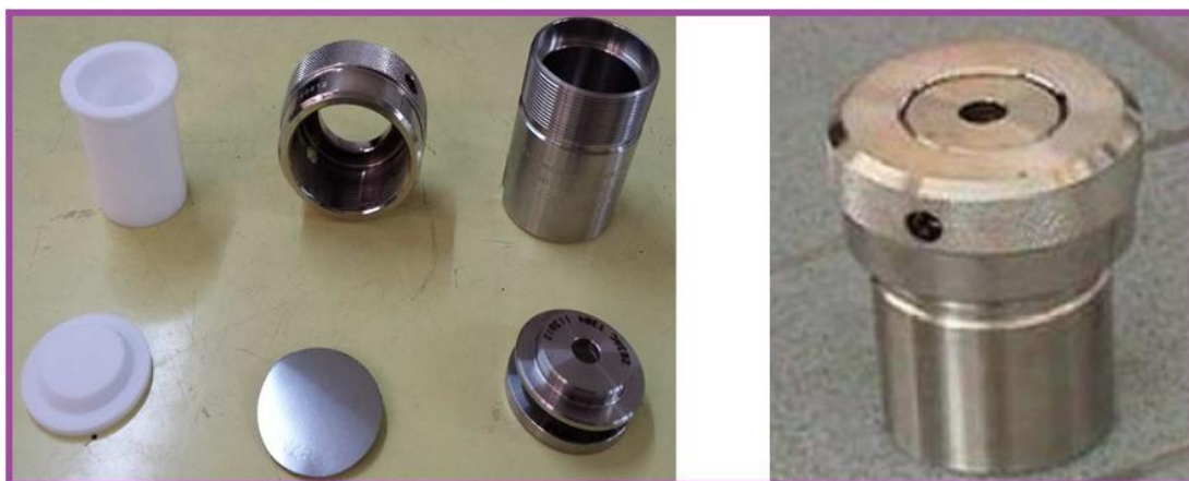
Figure (2) : Photo des accessoires de l'autoclave utilisé pour la synthèse hydrothermale.
