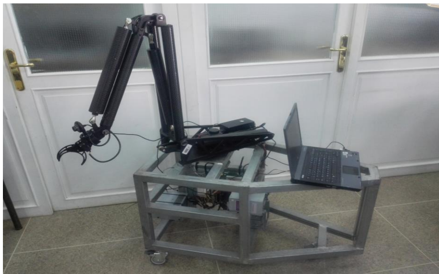
Figure 26 : Système de commande du bras robotique.
