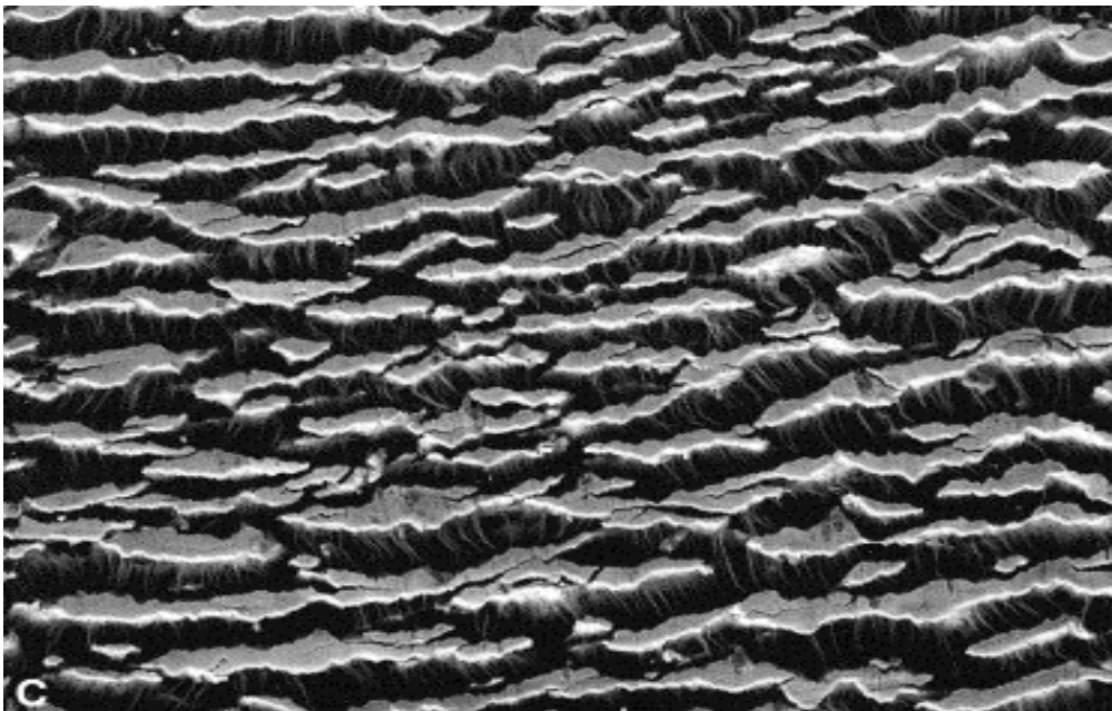
Figure 8: Vue en microscopie électronique à balayage (*250) de la surface liminale d'une prothèse en Polytétrafluoroéthylène expansé ne comportant pas d'enrubannage externe.
