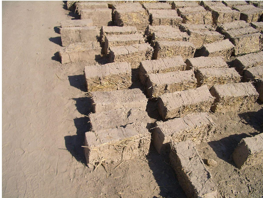
Figure 1. La construction par l'adobe.
