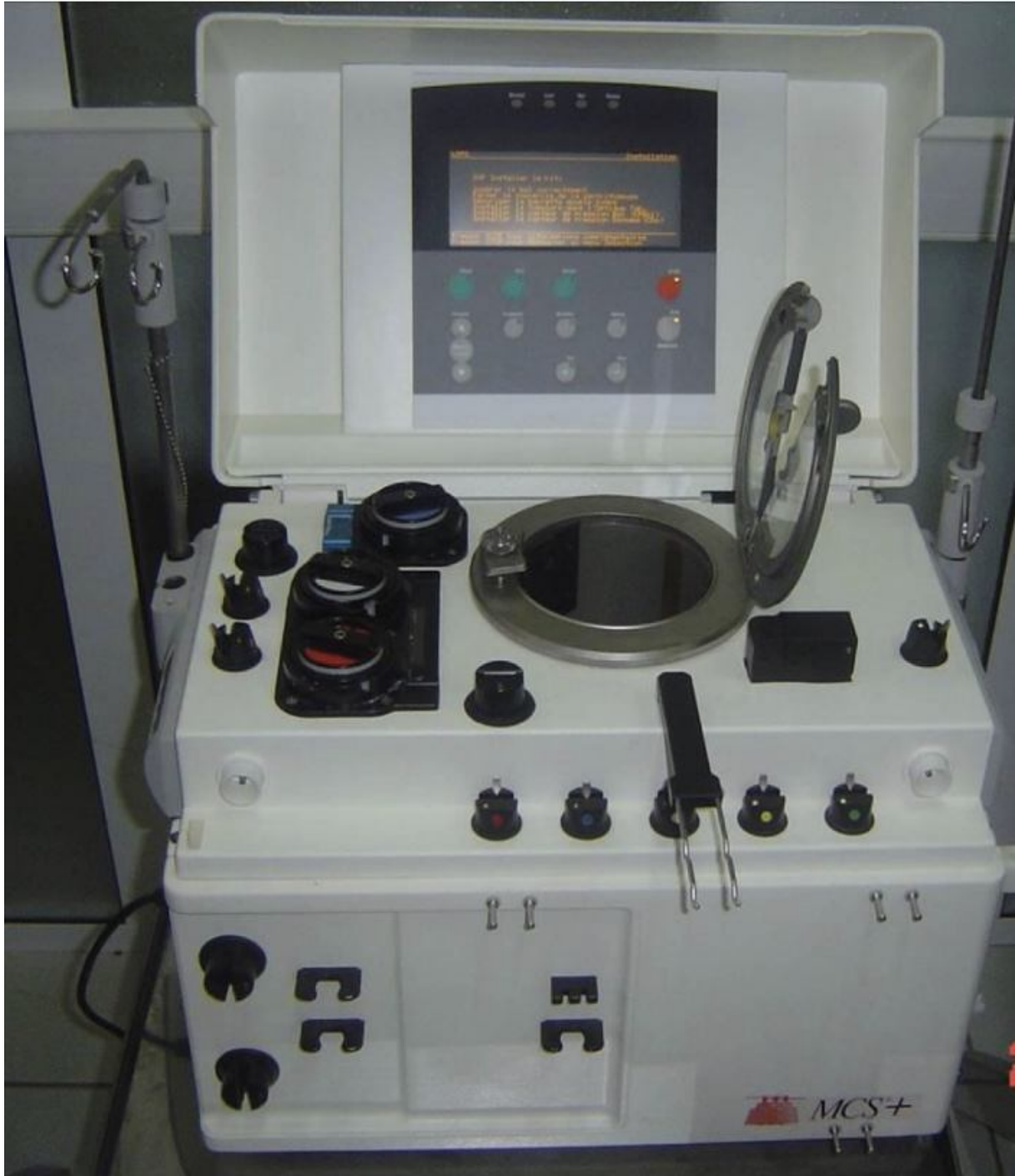
Figure 13: Le séparateur MCS+ d'Haemonetics à flux discontinu utilisé par le CTS
