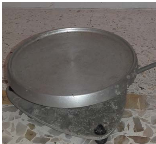
Figure n°3 : Débitmètre par système de pesée avec pot de recueil d'urine
