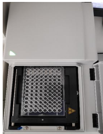
Figure 35 : Lecteur de plaque ELISA. (Photo au laboratoire d'Auto-Immunité-INH)
