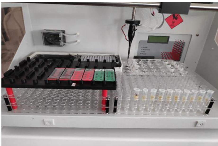
Figure 32 : Technique IFI dans l'automate BioRad PhD.(Photo prise au laboratoire d'Auto-Immunité-INH)
