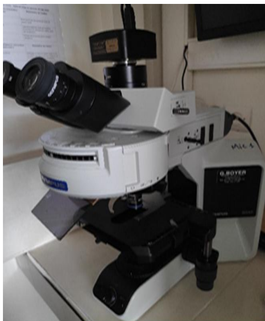
Figure 33 : Microscope à UV pour lecture des lames à IFI.(photo au laboratoire d'Auto immunité-INH)
