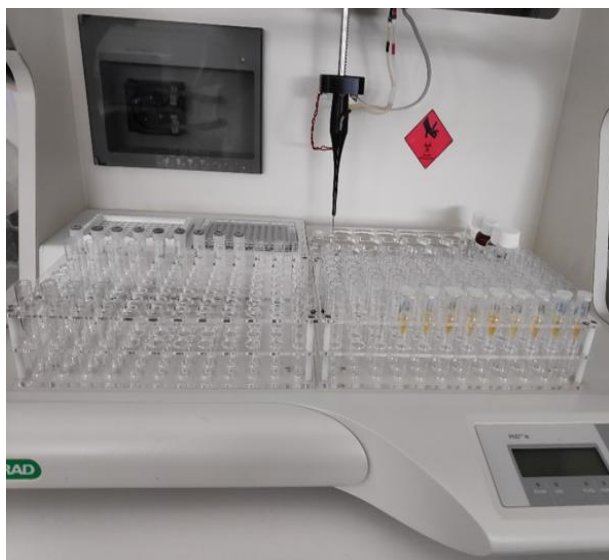
Figure 34 : Technique ELISA dans l'automate PhD lx. (Photo au laboratoire d'Auto-Immunité-INH)
