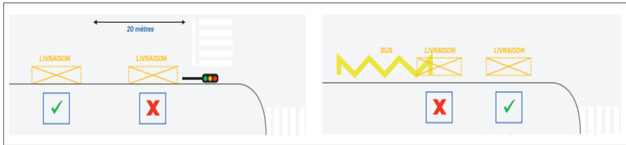
Figure 28. Exemple de localisation d'une aire de livraison
