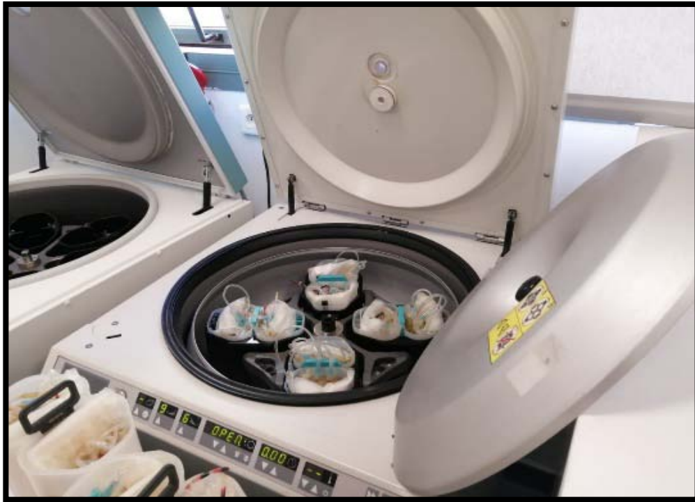
Figure 8 : Centrifugeuse réfrigérée pour poche à sang au CTS de l'HMA de Marrakech
