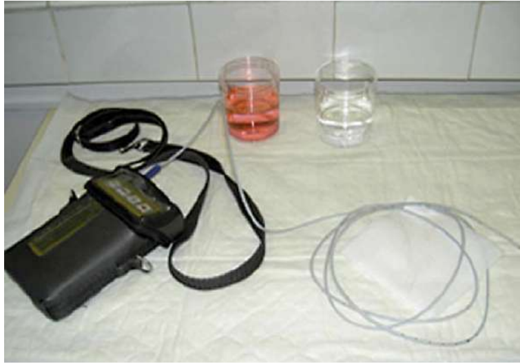
Figure 24 : Étalonnage d'un pH-mètre avec une sonde à usage unique[127]
