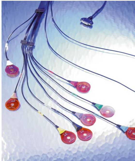
Figure 50: Sensor Array ou réseau d'antennes (10).
