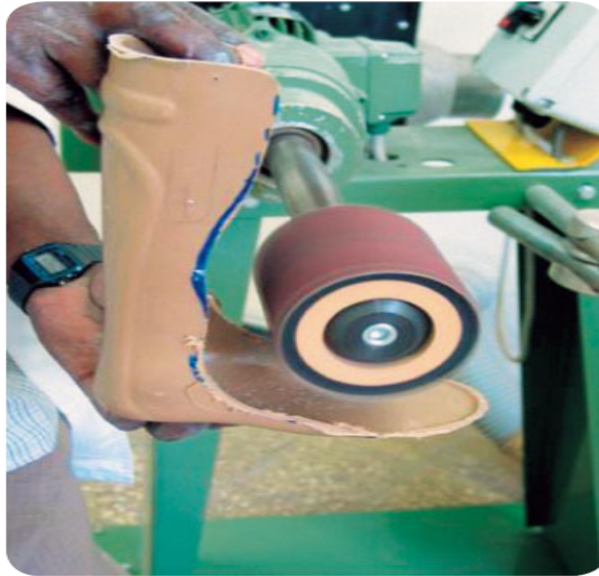
Figure 39: Fraiseuse utilisée pour poncer et lisser les bords de l'orthèse (29).
