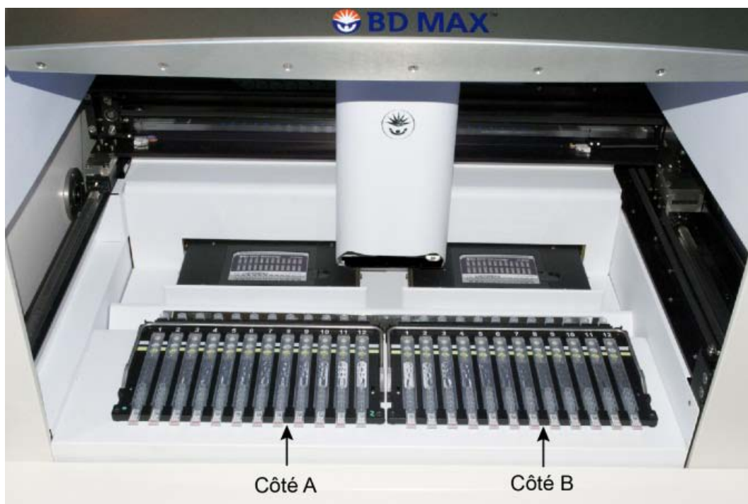
Figure 28 : Chargement du ou des portoirs sur le BD MAX System [135].
