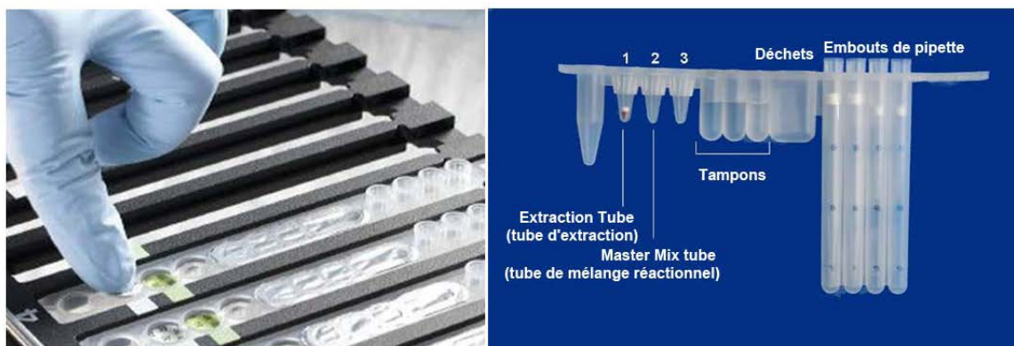
Figure 26 : Enclenchement des BD MAX MRSA Extraction Tubes et Master Mix Tubes dans les barrettes réactives unitarisées [135].
