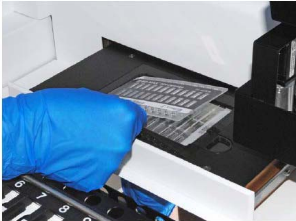
Figure 27 : Chargement des BD MAX PCR Cartridges [135].
