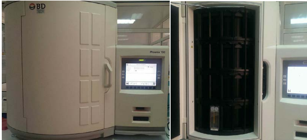
Figure 9: Le système d'identification d'antibiogramme automatisé BD Phoenix T (Photo prise au laboratoire de microbiologie du CHU Mohamed VI de Marrakech)
