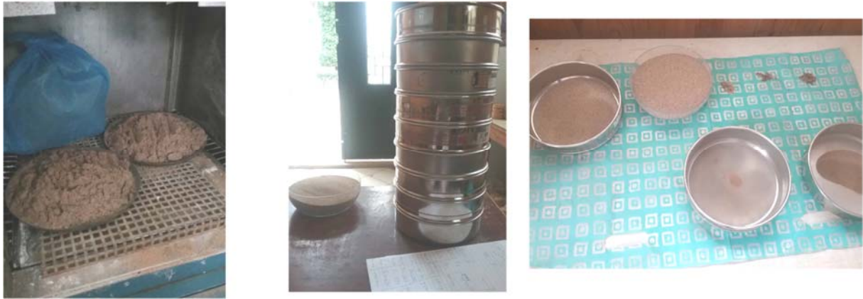
Figure II- 5: Lavage, séchage à 105 °C et tamisage du sable
