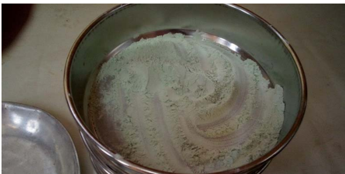
Annexe- 3: Procédure de broyage et de tamisage de la poudre de verre
