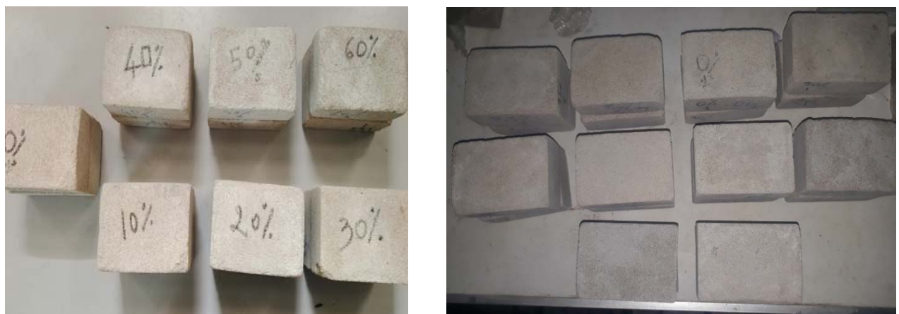
Figure II- 11: Échantillons des mortiers témoin et substitués à différents pourcentages de la poudre de verre
