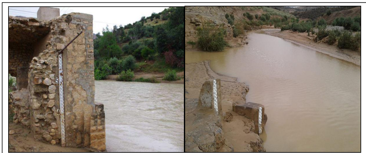
Photos. n°2 : Station hydrométrique d'Azzaba(X: 559,95 -Y: 359,57)(G) et Ait Khabache (X: 557 - Y: 314,8 ) (D) dans le Haut Sebou.
