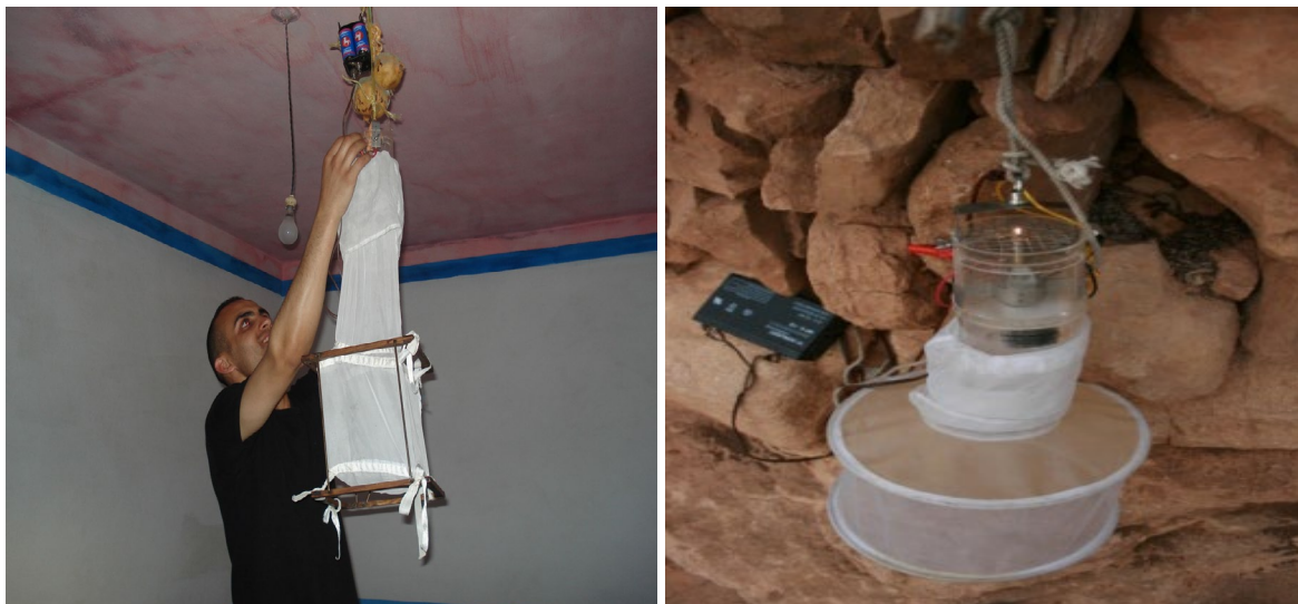
Figure 27 : Piège lumineux "type CDC miniature"
