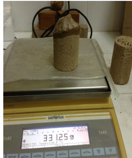
Figure IV-16: Epreuve cylindrique après le test d'absorption d'eau par capillarité
