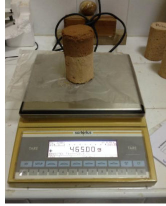
Figure IV-14: Pesage des échantillons humides
