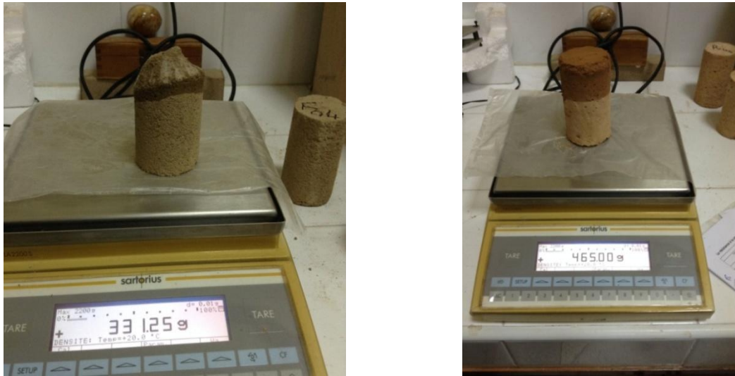
Figure IV-39: A gauche éprouvette non stabilisée, A droite éprouvette stabilisée
