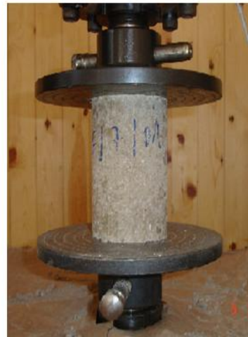
Figure III-7: Dispositif d'essai de compression
