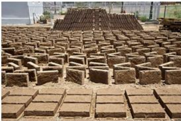
Adobe au séchage sous le soleil
