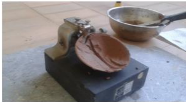
Figure II-20: Essai de liquidité; Appareil de Casagrande
