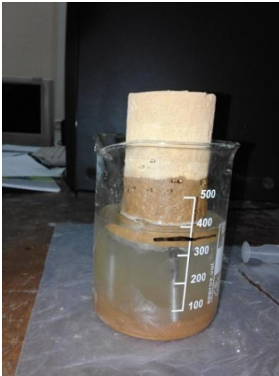
Figure IV-16: Epreuve cylindrique après le test d'absorption d'eau par capillarité
