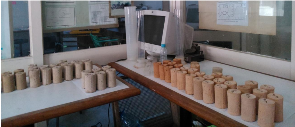
Figure IV-18: Les éprouvettes de mortier de deux terres F et R
