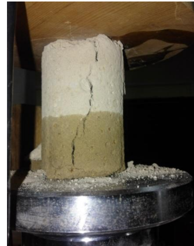
Figure IV-17: Epreuve cylindrique stabilisée après le test d'absorption d'eau par capillarité et après l'essai de compression
