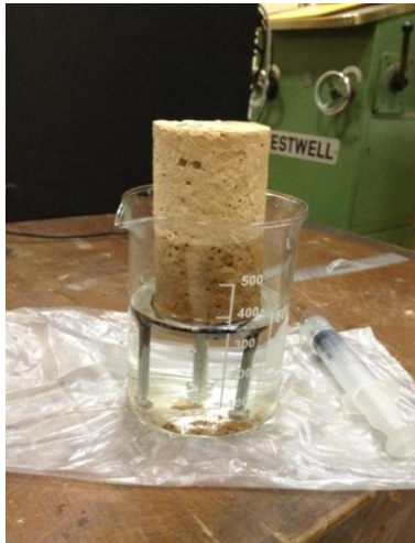
Figure IV-17: Epreuve cylindrique stabilisée après le test d'absorption d'eau par capillarité et après l'essai de compression
