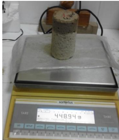
Figure IV-17: Epreuve cylindrique stabilisée après le test d'absorption d'eau par capillarité et après l'essai de compression
