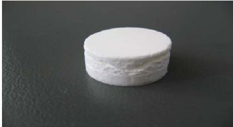
Figure 80. Clivage d'un compact de lactose après éjection(208).
