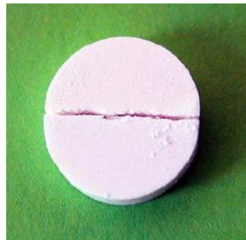
Fig.137 : Rupture diamétrale d'un compact plat de cellulose microcristalline Vivapur 102 . (196).
