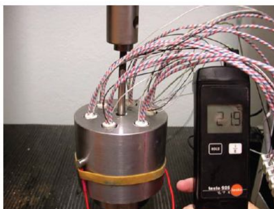
Fig.99 : Matrice uniaxiale avec 6 trous cylindriques pour introduire les 6 carottes constituant le dispositif de chauffage. Un capteur piezo-électrique pour l'émission acoustique est visible sur la gauche(209).
