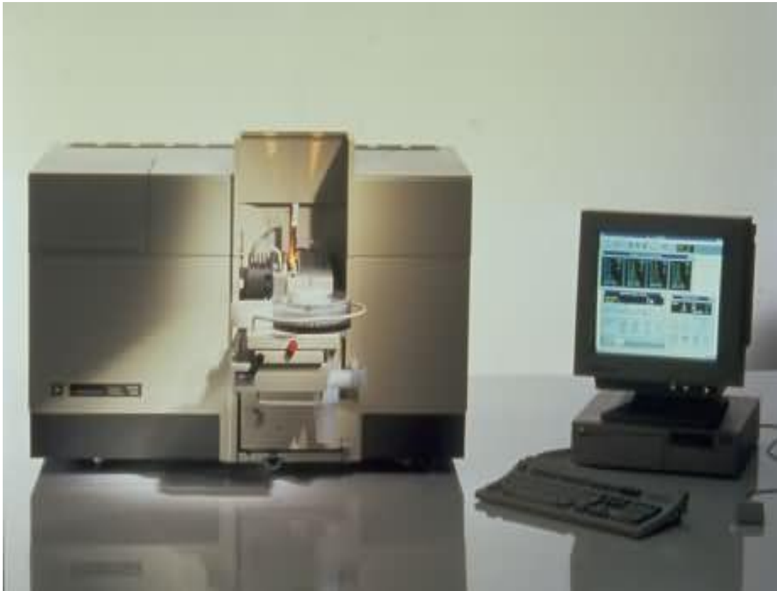
Figure 44 : Photographie du spectromètre d'absorption atomique Perkin Elmer GFAAS SIMAA
