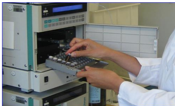
Figure 56 : Appareil d'HPLC couplé à un détecteur de fluorescence
