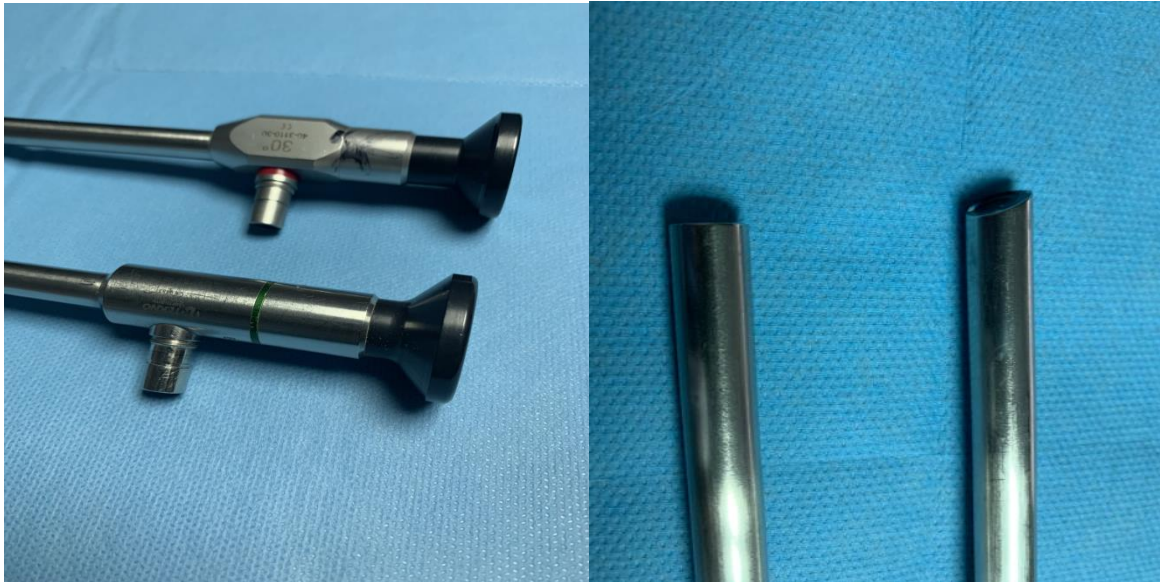
Figure 17: L'optique de 10mm, 0 degré (en vert, extrémité droite) et 30 degré (en rouge, extrémité biseautée), (Uro B, Hôpital Ibn Sina).
