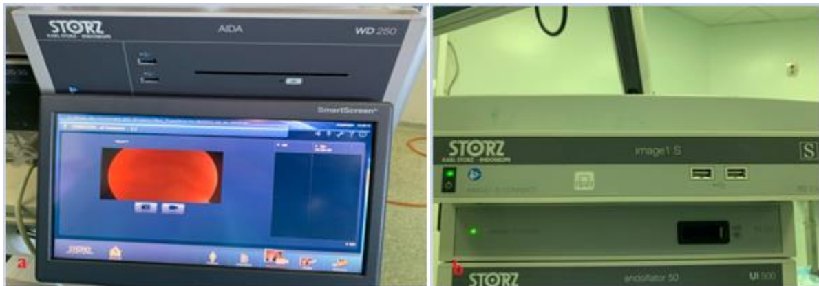
Figure 20: Enregistreur intégré sur colonne (a) ou avec un disque dur externe (b), (Uro B, HIS).
