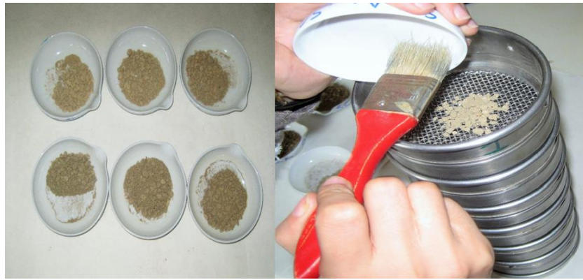
Sol sec passera par la série des six tamis
