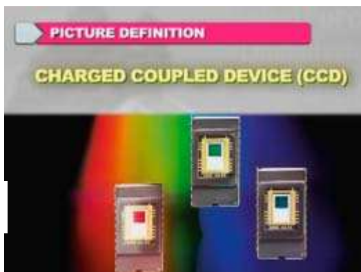
Figure 2 : 2 CCD Transforme l'image réelle en un signal électronique
